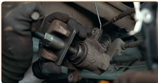
**16** Montare la pinza del freno e fissarla.
