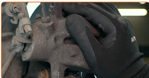
**17** Serra gli elementi di fissaggio della pinza del freno. Utilizza una chiave combinata N°13. Utilizza una chiave a bussola N°13. Usa una chiave dinamometrica. Serralo fino allo coppia di torsione di 30 Nm.
