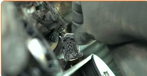
**4** Svitare l'elemento di fissaggio del sensore di posizione dell'albero a camme. Utilizzare una chiave a bussola da 10 mm. Utilizzare una chiave a cricchetto.
