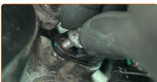
**13** Serrare l'elemento di fissaggio del sensore di posizione dell'albero a camme. Utilizzare una chiave a bussola da 10 mm. Utilizzare una chiave dinamometrica. Coppia di serraggio: 10 N·m.
