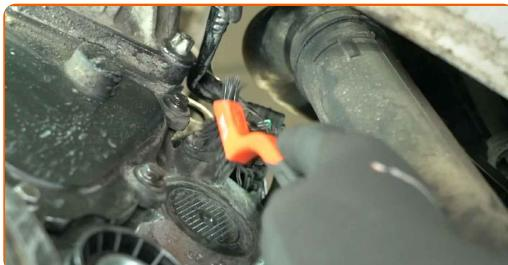
**3** Staccare il connettore del sensore di posizione dell'albero a camme.
