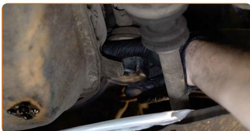
**11** Prepara un contenitore per il filtro dell'olio vecchio. Metti il vecchio filtro dell'olio nel contenitore.
