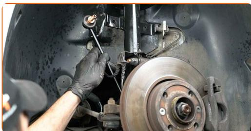
**12** Serra gli elementi di fissaggio che collegano il tirante della barra stabilizzatrice alla barra. Utilizza una chiave a bussola N°17. Usa una chiave dinamometrica. Serralo fino allo coppia di torsione di 44 Nm.
