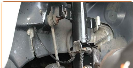
**Sostituzione: biellette barra stabilizzatrice - RENAULT Trafic II Bus (JL).**
