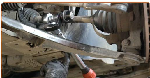
**13** Serra gli elementi di fissaggio che collegano il tirante della barra stabilizzatrice al puntone dell'ammortizzatore. Utilizza una chiave a bussola N°17. Usa una chiave dinamometrica. Serralo fino allo coppia di torsione di 44 Nm.
