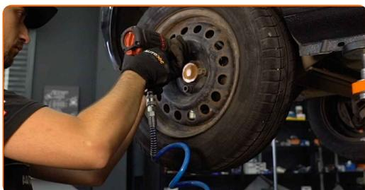
**17** Rimettere il veicolo per terra e, lavorando in ordine incrociato, serrare i bulloni di fissaggio delle ruote. Usa una chiave dinamometrica. Serralo fino allo coppia di torsione di 90 Nm.
