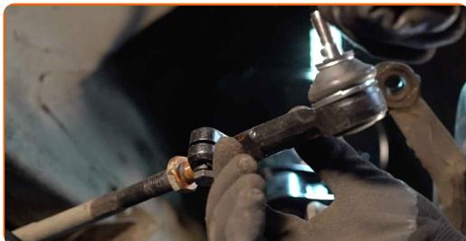
Sostituzione: testine sterzo - RENAULT Scénic I (JA0/1, FA0). AUTODOC raccomanda:
