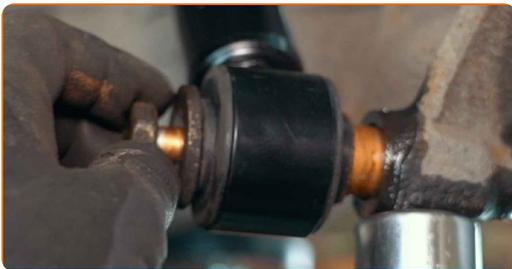
**19** Avvita gli elementi di fissaggio inferiori dell'ammortizzatore. Utilizza una chiave a bussola N°21. Usa una chiave a cricchetto.
