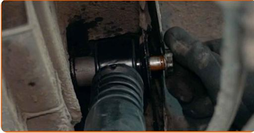
**16** Avvita gli elementi di fissaggio superiori dell'ammortizzatore. Usa la chiave a bussola 12 punte n.21. Usa una chiave a cricchetto.
