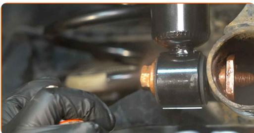
**21** Avvita gli elementi di fissaggio superiori dell'ammortizzatore.
