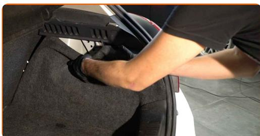
**5** Pulisci gli elementi di fissaggio dell'ammortizzatore. Usa una spazzola metallica. Usa lo spray WD-40.
