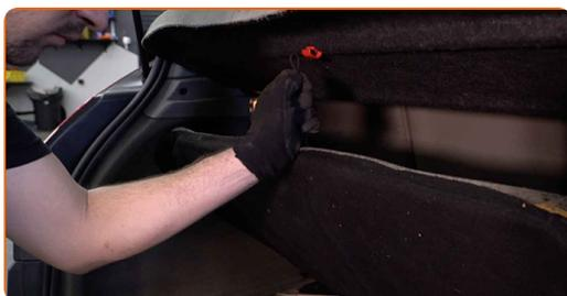
**3** Svita l'elemento di fissaggio superiore dell'ammortizzatore. Utilizza una chiave a bussola N°16. Usa una chiave a cricchetto.
