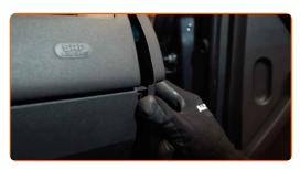
Installa la copertura in plastica laterale. Posiziona il pezzo usando le guide e serra gli elementi di fissaggio.
