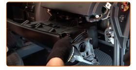
Avvitare le viti di fissaggio del vano portaoggetti. Usa la chiave Torx T20.
