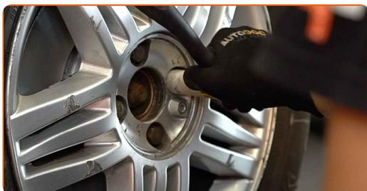
**22** Rimettere il veicolo per terra e, lavorando in ordine incrociato, serrare i bulloni di fissaggio delle ruote. Usa una chiave dinamometrica. Serralo fino allo coppia di torsione di 110 Nm.
