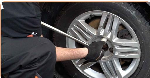
**3** Allentare i bulloni di fissaggio della ruota. Usa la chiave a bussola per dadi cerchio ruota n.19.
