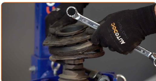
24 Installare un nuovo elemento di montaggio del supporto di ammortizzazione superiore.
