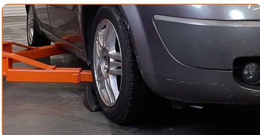
**4** Allentare i bulloni di fissaggio della ruota. Usa la chiave a bussola per dadi cerchio ruota n.19.
