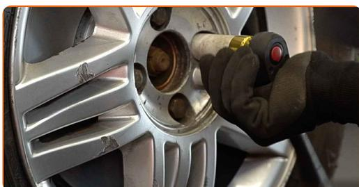
**24** Rimettere il veicolo per terra e, lavorando in ordine incrociato, serrare i bulloni di fissaggio delle ruote. Usa una chiave dinamometrica. Serralo fino allo coppia di torsione di 110 Nm.
