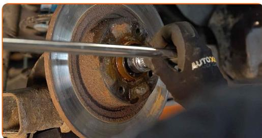
**19** Rimuovi il disco freno assemblato con il cuscinetto del mozzo della ruota.
