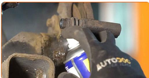
**14** Svitare l'attacco della staffa pinza freno. Utilizza una chiave a bussola N°E16. Usa un giramaschi.
