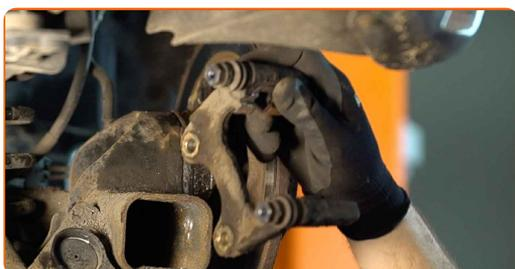
**16** Pulisci la superficie del disco freno. Usa una spazzola metallica. Usa lo spray WD-40.
