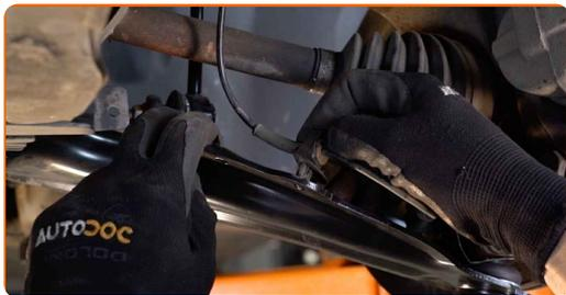
**49** Installa i parasassi del passaruota alla loro sede di montaggio..
