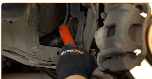
Sostituzione: braccio inferiore anteriore - RENAULT MEGANE II (BM0/1\_, CM0/1\_). Gli esperti di AUTODOC raccomandano:
