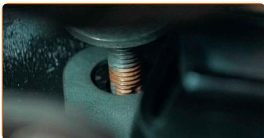
**15** Montare la staffa del supporto motore.
