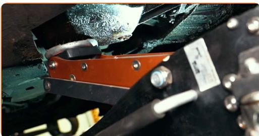
**4** Pulisci gli elementi di fissaggio del supporto del motore. Usa una spazzola metallica. Usa lo spray WD-40.
