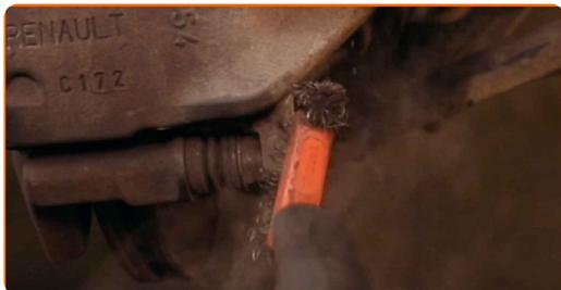
**8** Svitare l'attacco della pinza freno. Utilizza una chiave combinata N°17. Utilizza una chiave a bussola N°13. Usa una chiave a cricchetto.
