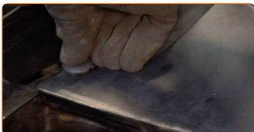
**15** Installa la guarnizione griglia sottoparabrezza.
