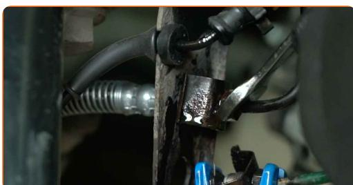
**29** Stringere il raccordo a dado che collega il tubo flessibile al condotto del freno. Completare gli stessi passaggi per l'altro tubo flessibile del freno. Utilizzare una chiave dinamometrica. Utilizzare una chiave a bussola per dadi svasati da 11 mm. Coppia di serraggio: 17 N·m.
