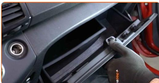
**3** Svitare le viti di montaggio del vano portaoggetti. Usa un cacciavite Phillips.
