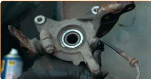
**30** Esercitando una pressione, estrarre il mozzo dal fuso a snodo. Usare un set di montaggio/smontaggio cuscinetti e boccole.
