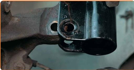
**29** Rimuovere il fuso a snodo dello sterzo insieme al mozzo della ruota.
