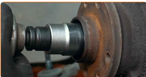
**27** Scollega l'albero di trasmissione dal fuso a snodo. Rimuovi i bulloni di fissaggio.
