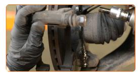
Pulisci gli elementi di fissaggio del disco freno. Usa una spazzola metallica. Usa lo spray WD-40.
