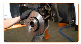
Serrare l'attacco del disco freno. Usa la chiave Torx T 30. Usa una chiave dinamometrica. Serralo fino allo coppia di torsione di 9 Nm.
