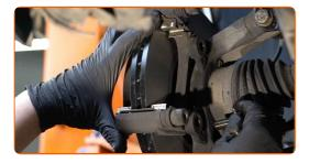
Serrare il sostegno pinza freno. Utilizza una chiave a bussola N°18. Usa una chiave dinamometrica. Serralo fino allo coppia di torsione di 105 Nm.
