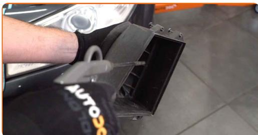
Sostituzione: filtro aria - RENAULT Laguna I Hatchback (B56). Il consiglio di AUTODOC:
