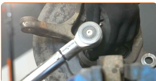
**40** Trattare l'elemento di fissaggio del sensore ABS. Usa un grasso multiuso.
