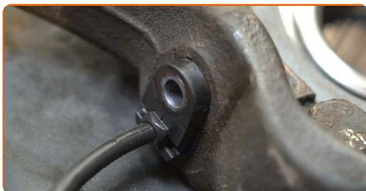
**42** Stringere l'elemento di fissaggio che collega il sensore ABS al fuso a snodo. Utilizza una chiave a bussola N°10. Usa una chiave dinamometrica. Serralo fino allo coppia di torsione di 13 Nm.
