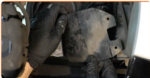
**11** Svitare i bulloni della staffa di fissaggio del filtro carburante. Utilizza una chiave combinata N°10.
