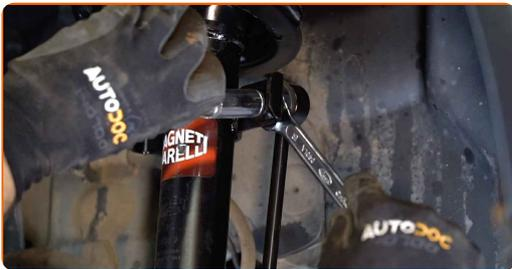
**12** Serra gli elementi di fissaggio che collegano il tirante della barra stabilizzatrice alla barra. Utilizza una chiave a bussola N°14. Utilizza una chiave combinata N°15. Usa una chiave dinamometrica. Serralo fino allo coppia di torsione di 44 Nm.
