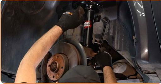
**11** Serra gli elementi di fissaggio che collegano il tirante della barra stabilizzatrice al puntone dell'ammortizzatore. Utilizza una chiave a bussola N°14. Utilizza una chiave combinata N°15. Usa una chiave dinamometrica. Serralo fino allo coppia di torsione di 44 Nm.
