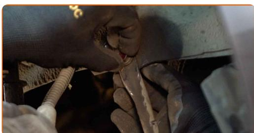
**41** Avvita gli elementi di fissaggio della staffa della barra di rinforzo del paraurti. Utilizza una chiave a bussola N°18. Usa una chiave dinamometrica. Serralo fino allo coppia di torsione di 70 Nm.
