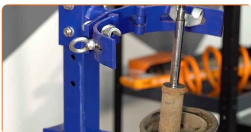
23 Installare il parapolvere e i paracolpi sul nuovo ammortizzatore.
