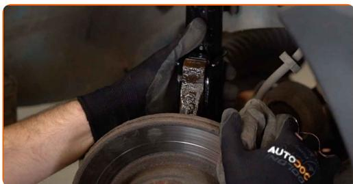
**33** Installa e avvita i nuovi bulloni del fuso a snodo. Utilizza una chiave a bussola N°21. Utilizza una chiave combinata N°21. Usa una chiave dinamometrica. Serralo fino allo coppia di torsione di 140 Nm.
