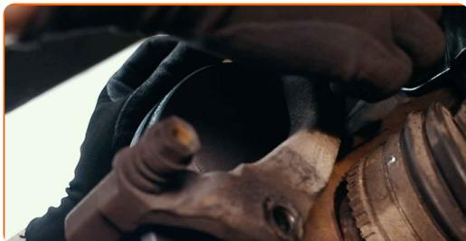
23 Serrare il sostegno pinza freno. Utilizza una chiave a bussola N°18. Usa una chiave dinamometrica. Serralo fino allo coppia di torsione di 100 Nm.
