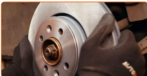
20 Serrare l'attacco del disco freno. Usa la chiave Torx T40. Usa una chiave dinamometrica. Serralo fino allo coppia di torsione di 14 Nm.
