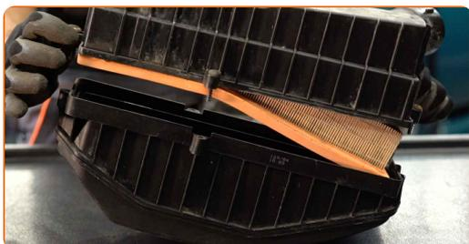
9 Rimuovere dall'alloggiamento del filtro l'elemento filtrante da sostituire.
