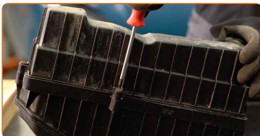
**14** Montare la carcassa del filtro d'aria.
