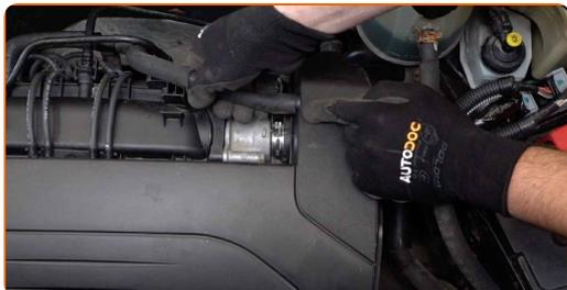
**4** Svita il morsetto che serra l'alloggiamento del filtro aria del motore al corpo della farfalla. Usa un giravite piatto.
