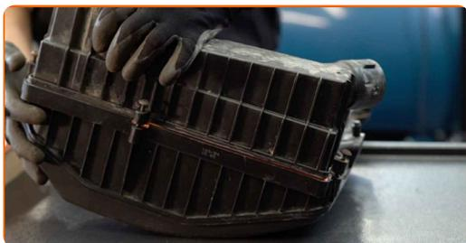
**13** Avvita le viti di serraggio sul coperchio del filtro dell'aria. Usa la chiave Torx T25.
