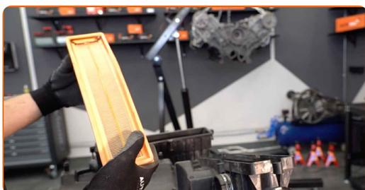
**10** Pulisci il coperchio del filtro dell'aria e l'alloggiamento.
