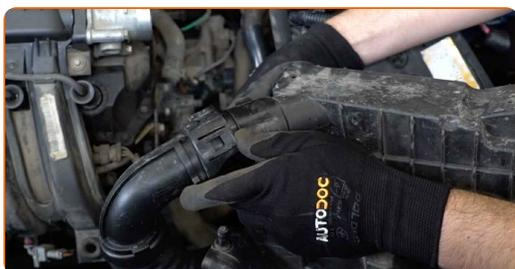
**16** Stringi il morsetto che serra l'alloggiamento del filtro aria del motore al corpo della farfalla. Usa un giravite piatto.
