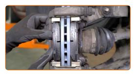
19 Installare la pinza del freno e fissarla.
