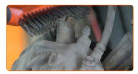
Svitare gli elementi di fissaggio della pinza del freno. Utilizza una chiave combinata N°13. Utilizza una chiave combinata N°15.
