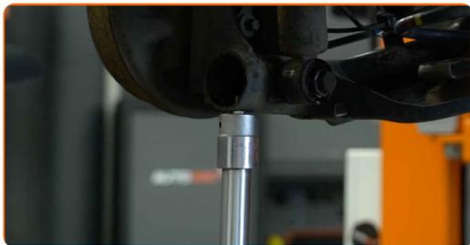
**13** Avvita l'elemento di fissaggio inferiore dell'ammortizzatore. Utilizza una chiave a bussola N°18. Usa una chiave a cricchetto.
