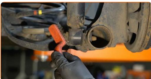
**8** Sostieni la traversa posteriore della sospensione. Usa un cric idraulico per trasmissione.
