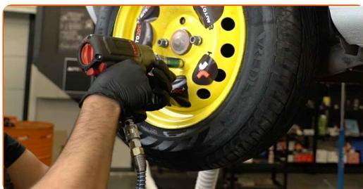
**35** Rimettere il veicolo per terra e, lavorando in ordine incrociato, serrare i bulloni di fissaggio delle ruote. Usa la chiave a bussola per dadi cerchio ruota n.17. Usa una chiave dinamometrica. Serralo fino allo coppia di torsione di 105 Nm.
