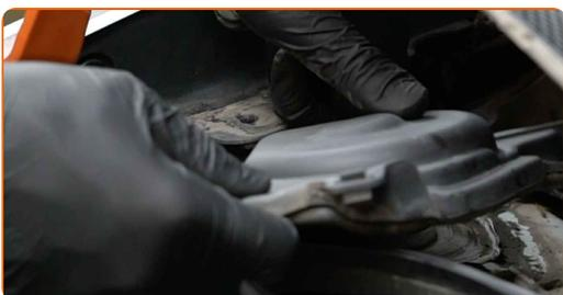
**8** Pulisci gli elementi di fissaggio del supporto superiore del puntone dell'ammortizzatore. Usa una spazzola metallica. Usa lo spray WD-40.
