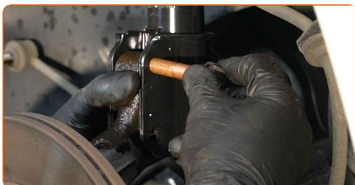
**51** Avvita l'elemento di fissaggio che collega il puntone dell'ammortizzatore al fuso a snodo. Utilizza una chiave combinata N°18. Utilizza una chiave a bussola N°18. Usa una chiave a cricchetto.
