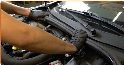
**73** Rimuovi la copertura di protezione del parafrango.
