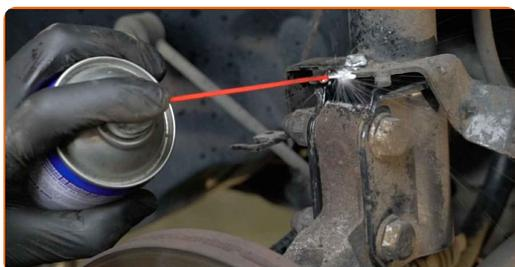
**20** Svitare la staffa di fissaggio del tubo flessibile freno dal supporto di ammortizzazione. Utilizza una chiave a bussola N°10. Usa una chiave a cricchetto.
