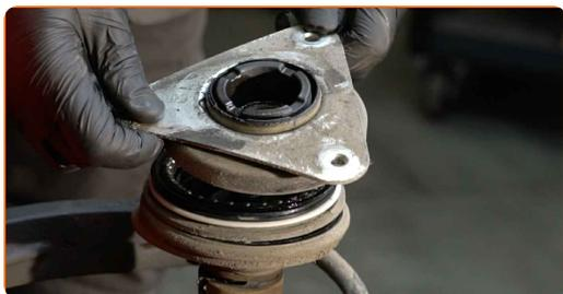
**34** Rimuovi il parapolvere e il paracolpi dell'ammortizzatore.
