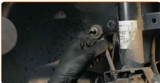
**18** Scollegare il cablaggio del sensore ABS. Usa un piede di porco.
