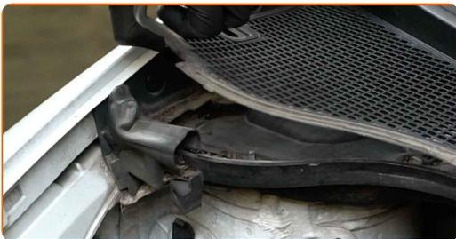
**6** Svitare gli elementi di fissaggio del coperchio del supporto puntone di sospensione. Utilizza una chiave a bussola N°10. Usa una chiave a cricchetto.
