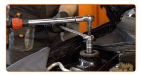
Tratta con del prodotto gli elementi di fissaggio del supporto del puntone dell'ammortizzatore. Usa il grasso al rame.
