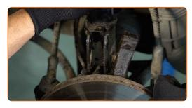
Svita l'elemento di fissaggio superiore del montante supporto ammortizzazione. Utilizza una chiave a bussola N°21.
