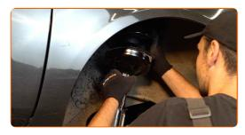
Avvita l'elemento di fissaggio superiore del montante supporto ammortizzazione. Non lo serrare.
