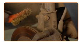
Svita gli elementi di fissaggio che collegano il puntone dell'ammortizzatore al fuso a snodo. Utilizza una chiave combinata N°18. Utilizza una chiave a bussola N°18. Usa un giramaschi.
