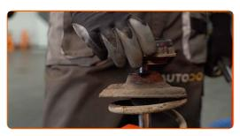
Rimuovi il parapolvere e il paracolpi dell'ammortizzatore.
