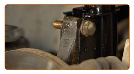
Avvita l'elemento di fissaggio che collega il puntone dell'ammortizzatore al fuso a snodo. Utilizza una chiave combinata N°18. Utilizza una chiave a bussola N°18.
