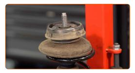
Serrare la vite dell'asta pistone supporto ammortizzazione. Utilizza una chiave a bussola N°17. Usa una chiave HEX N.H6. Usa una chiave dinamometrica. Serralo fino allo coppia di torsione di 21 Nm.
