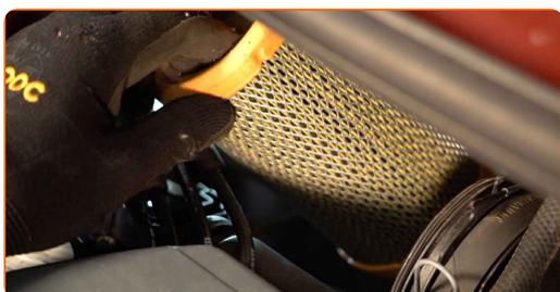
**6** Pulisci il coperchio del filtro dell'aria e l'alloggiamento.
