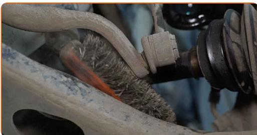
**9** Svita gli elementi di fissaggio che collegano il tirante della barra stabilizzatrice alla barra. Utilizza una chiave a bussola N°14. Usa una chiave a cricchetto.
