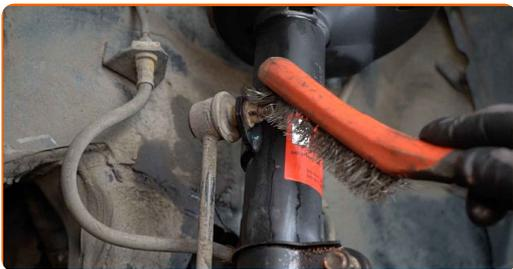
**7** Svita gli elementi di fissaggio che collegano il tirante della barra stabilizzatrice al puntone dell'ammortizzatore. Utilizza una chiave a bussola N°14. Usa una chiave a cricchetto.
