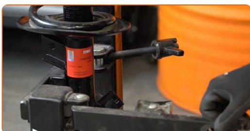
**44** Tratta con del prodotto le sedi di montaggio del puntone dell'ammortizzatore. Usa una spazzola metallica. Usa lo spray WD-40.
