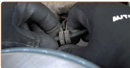
**22** Pulisci gli elementi di fissaggio che collegano il puntone dell'ammortizzatore al fuso a snodo. Usa una spazzola metallica. Usa lo spray WD-40.
