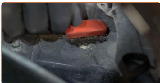
**10** Allenta gli elementi di fissaggio superiori del supporto dell'ammortizzatore. Utilizza una chiave a bussola N°13. Usa una chiave a cricchetto.
