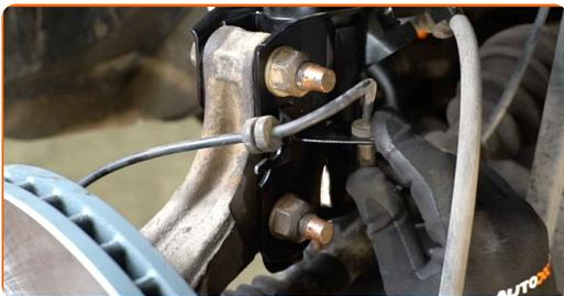
**54** Fissare sul montante il tubo dell'impianto freni.
