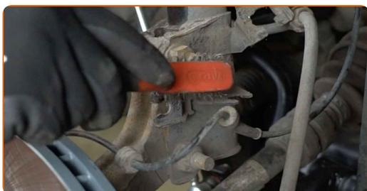
**23** Svita gli elementi di fissaggio che collegano il puntone dell'ammortizzatore al fuso a snodo. Utilizza una chiave combinata N°18. Utilizza una chiave a bussola N°21. Usa una chiave a cricchetto.
