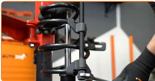
**39** Installa il nuovo supporto, il parapolvere e il tampone dell'ammortizzatore.
