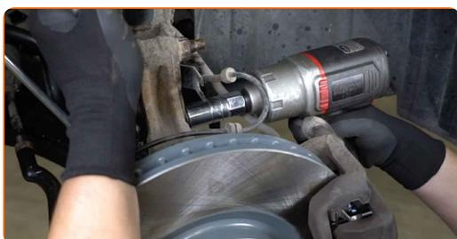
**24** Puntellare il fuso a snodo. Usa un cric idraulico per trasmissione.
