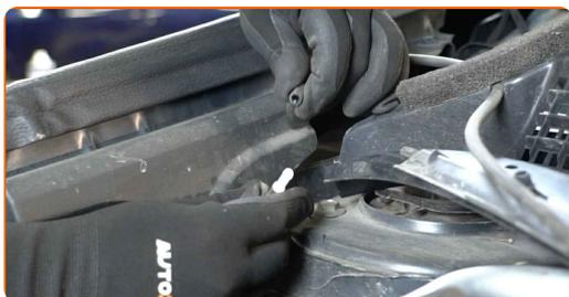
**9** Pulisci gli elementi di fissaggio del supporto superiore del puntone dell'ammortizzatore. Usa una spazzola metallica. Usa lo spray WD-40.
