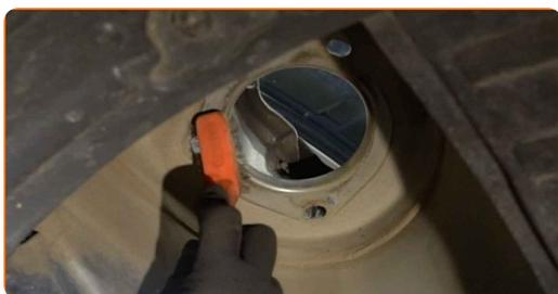
**45** Installare il supporto di ammortizzazione nell'arco passaruota.
