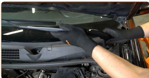
**6** Rimuovi le clip dalla griglia di ventilazione di plastica. Usa uno strumento per estrazione clip.
