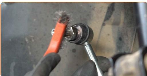
**57** Installa il puntone stabilizzatore trasversale.
