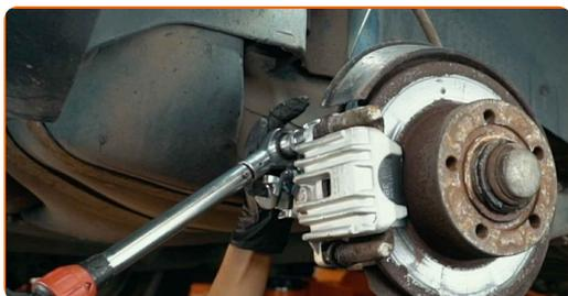
**19** Installa il cavo del freno di stazionamento nella staffa della pinza del freno. Usa le pinze per pompa ad acqua. Usa un piede di porco.
