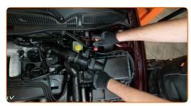
Scollega il connettore del debimetro. Allentare il morsetto e rimuovere il tubo di aspirazione aria dal'alloggiamento del filtro. Usa le pinze unversali.
