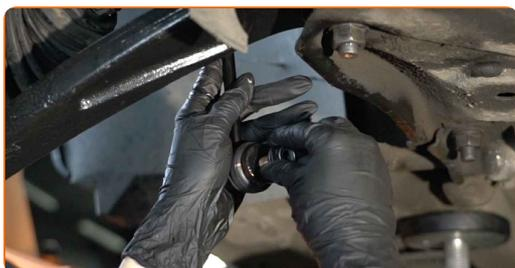
**14** Serra gli elementi di fissaggio che collegano il tirante della barra stabilizzatrice alla barra. Utilizza una chiave a bussola N°17. Usa una chiave dinamometrica. Serralo fino allo coppia di torsione di 36 Nm.
