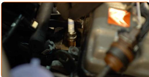
**18** Avvitare le nuove candele e serrarle. Usa la chiave a bussola per candele numero 16. Usa una chiave dinamometrica. Serralo fino allo coppia di torsione di 28 Nm.
