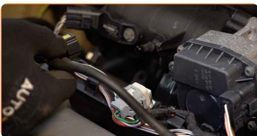
**4** Scollega il tubo di ventilazione del carter del motore dal collettore di aspirazione.
