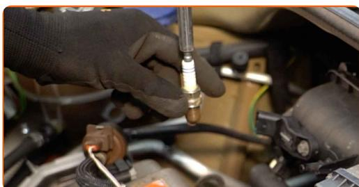
**16** Applica uno strato sottile dello speciale lubrificante antigrippaggio per alte temperature alle filettature delle candele nuove.
