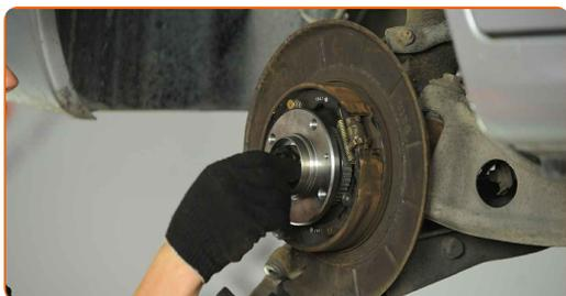
**23** Serrare l'attacco del mozzo. Utilizza una chiave a bussola N°41. Usa una chiave dinamometrica. Serralo fino allo coppia di torsione di 275 Nm.
