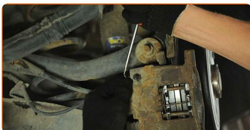
**8.1** Svitare gli elementi di fissaggio della pinza del freno. Usa una chiave HEX N.H7.
