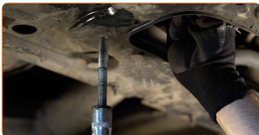
**15** Rimuovi l'elemento di fissaggio frontale del braccio di sospensione.
