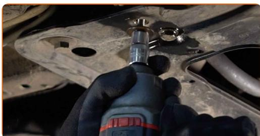
**14** Rimuovi l'elemento di fissaggio posteriore del braccio di sospensione.
