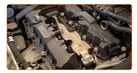
Serra gli elementi di fissaggio delle bobine di accensione. Usa la chiave Torx T 20. Usa una chiave dinamometrica. Serralo fino allo coppia di torsione di 8 Nm.
