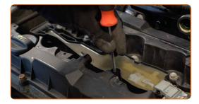
Installare i tubi flessibili di ventilazione del carter.
