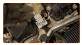
Installa le bobine di accensione ai fori delle candele. Assicurati di sentire un clic indicante che si trova installato saldamente.
