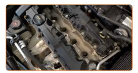
Applica uno strato sottile dello speciale lubrificante antigrippaggio per alte temperature alle filettature delle candele nuove.
