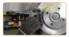
Installa il cavo del freno di stazionamento nella staffa della pinza del freno. Usa le pinze per pompa ad acqua. Usa delle pinze.
