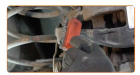
Sgancia il cavo del freno di stazionamento. Usa le pinze per pompa ad acqua. Usa delle pinze. Usa un piede di porco.
