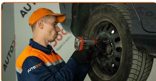
**38** Rimettere il veicolo per terra e, lavorando in ordine incrociato, serrare i bulloni di fissaggio delle ruote. Usa la chiave a bussola per dadi cerchio ruota n.19. Usa una chiave dinamometrica. Serralo fino allo coppia di torsione di 100 Nm.
