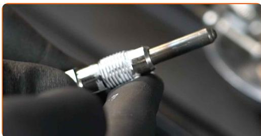
**17** Installare nuove candele nelle loro sedi di montaggio. Utilizzare pinze a naso lungo.
