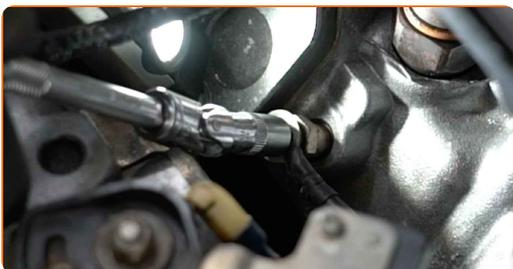
**11** Rimuovere i dadi di fissaggio. Usa un magnete telescopico.
