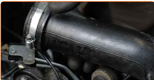
**9** Coprire l'ingresso del collettore di aspirazione con un asciugamano.
