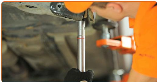
**23** Stringere l'elemento di fissaggio che collega il braccio di controllo al fuso posteriore. Utilizza una chiave combinata N°21. Utilizza una chiave a bussola N°21. Usa una chiave dinamometrica. Serralo fino allo coppia di torsione di 95 Nm.
