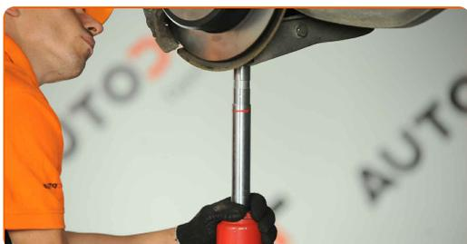
**7** Pulisci gli elementi di fissaggio dell'ammortizzatore. Usa una spazzola metallica. Usa lo spray WD-40.
