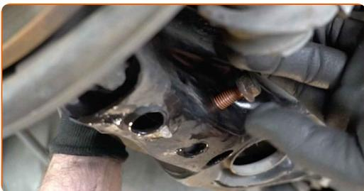
**22** Solleva il cric idraulico per trasmissione di 10-15 cm.
