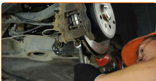
**24** Stringi l'elemento di fissaggio inferiore dell'ammortizzatore. Utilizza una chiave combinata N°18. Utilizza una chiave a bussola N°18. Usa una chiave dinamometrica. Serralo fino allo coppia di torsione di 75 Nm.
