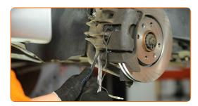
Rimuovi i bulloni di fissaggio (2 pezzi).
