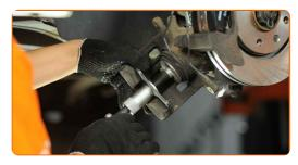
Montare la pinza del freno e fissarla.
