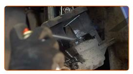
Premere il pistone della pinza freno. Usa un arretratore per pistoncini freni a disco.
