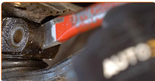
**58** Fissare il supporto di ammortizzazione sul fuso a snodo.
