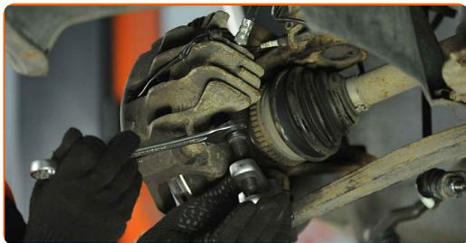
**17** Rimuovere la coppia di fissaggio del dado del mozzo. Usa delle pinze a becchi lunghi. Usa un giravite piatto.
