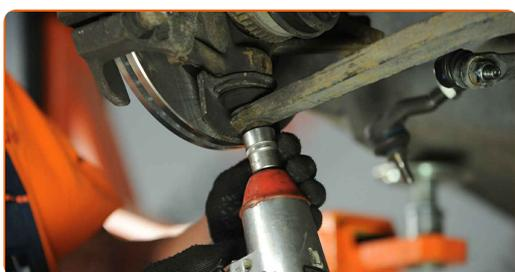
**16** Separare il giunto sferico dal braccio di controllo. Usa un estrattore del giunto sferico. Usa un piede di porco.
