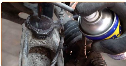
**57** Sgancia gli elementi di fissaggio che collegano il puntone dell'ammortizzatore al fuso a snodo. Usa uno scalpello piatto per la lavorazione dei metalli. Usa un martello.
