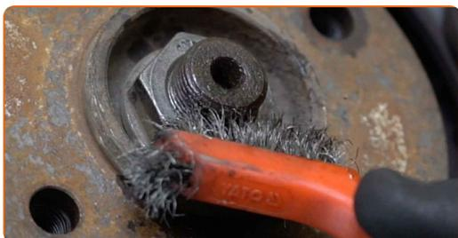
**19** Svitare il supporto di fissaggio del mozzo della ruota. Utilizza una chiave a bussola N°36. Usa una chiave a cricchetto.
