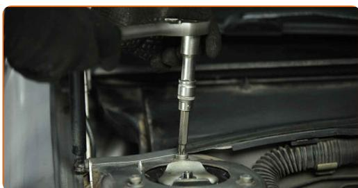
**53** Rimuovi la copertura di protezione del parafrangente.
