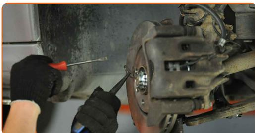
**18** Pulisci l'elemento di fissaggio del mozzo della ruota. Usa una spazzola metallica. Usa lo spray WD-40.
