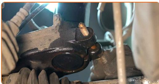
**60** Serrare i fermi inferiori del puntone di sospensione. Utilizza una chiave a bussola N°16. Usa una chiave dinamometrica. Serralo fino allo coppia di torsione di 55 Nm.
